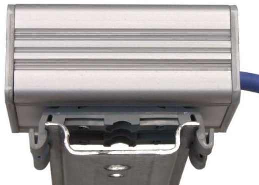
Fig. 5 – TME on the DIN rail
